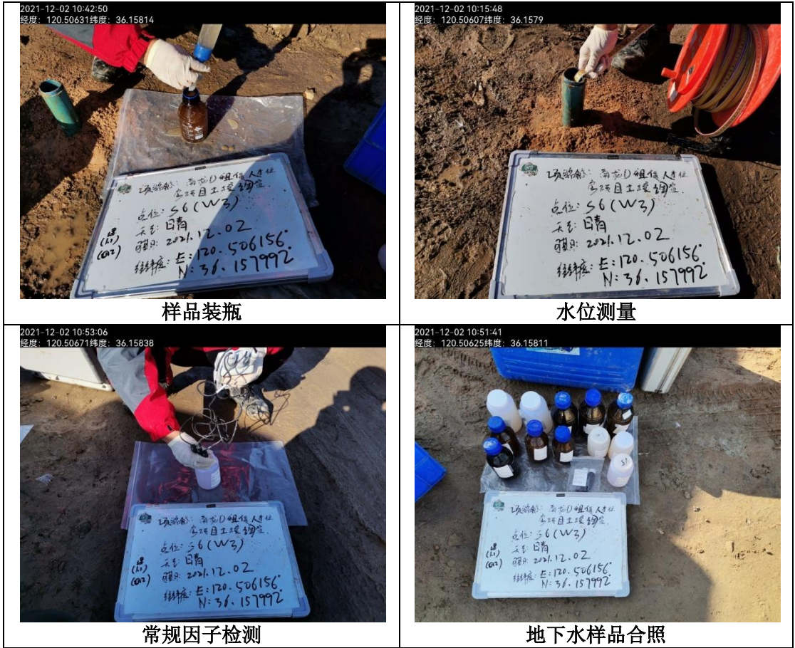
图4.7地下水建井、采样工作照片
