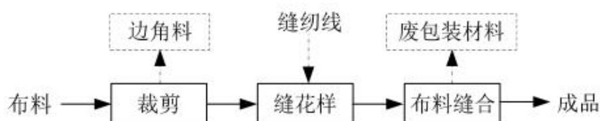
图 3.3-3 床上用品四件套生产工艺流程图
