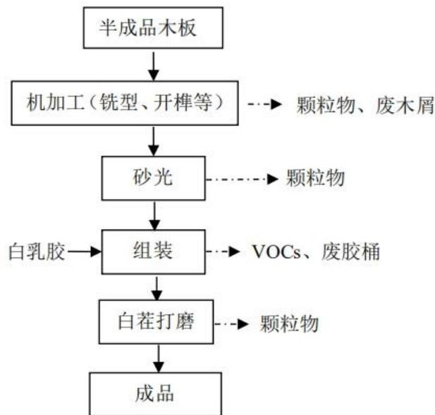
图 3.3-2 木制家具加工工艺流程图
